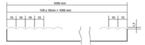
**Ribbed** ist eine geradlinig verlaufende Struktur in Form eines Rundstabprofils mit Verprägungen mit einer Breite von 7,5 mm. Die Tiefe der Verprägung beträgt 1,2 mm.
