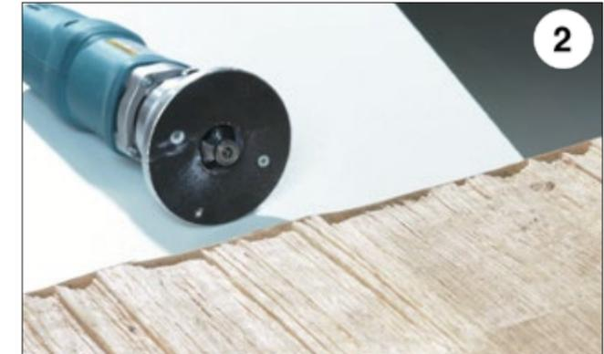
Überstände mit Profilfräser nacharbeiten. Es ist notwendig einen Anlauftring zur sauberen Führung zu montieren.
