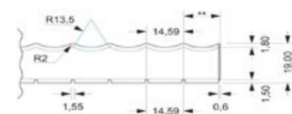
**Cave** ist eine geradlinig verlaufende Struktur in Form eines Rundstabprofils mit Verprägungen mit einer Breite von 14,5 mm. Die Tiefe der Verprägung beträgt 1,7 mm.
