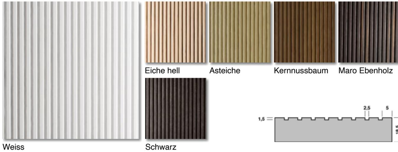
**Match** ist eine geradlinig verlaufende Struktur in Form eines Stabprofils mit Verprägungen in einem Abstand von 2,5 mm und einer Breite von 5,0 mm. Die Tiefe der Verprägung beträgt 1,5 mm.
