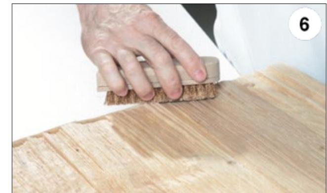
Struktur anschließend mit einer feinen Kupferdrahtbürste in Strukturrichtung säubern.
